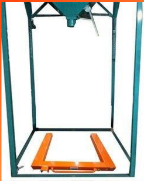
1.ホッパー下に スケールを設置
