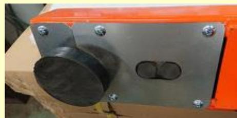
ネズミの侵入を防ぎ、はかり内部にあるケーブルをネズミに噛み切られないようにします。
